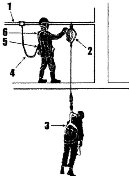
Система спасения и эвакуации, использующая средства защиты втягивающего типа со встроенной лебедкой.
